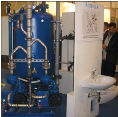
استفاده از سیستم مرکزی خلاء برای توالت‌ها. این تشکیلات برای سیفون مکشی است.
