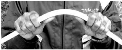
دقت کنید که شعاع خم با دست نباید از ۵ برابر قطر خارجی لوله کمتر باشد.
