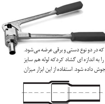
ابزار گشاد کن از جمله ابزارهای روتنبرگر است که در دونوع دستی و برقی عرضه می‌شود. با استفاده از این ابزار می‌توان از لوله‌های مسی را به اندازه‌ای گشاد کرده لوله هم سایز بدون استفاده از اتصالات در هم قرار گیرد و جوش داده شود. استفاده از این ابزار میزان مصرف اتصالات را بسیار کاهش می‌دهد.
